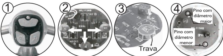
1- Com uma chave philips, retire o parafuso e a tampa para módulo.
