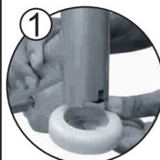
**1- Encaixe o Limitador de giro na região inferior do tubo de cachimbo (Região frontal do quadro).**
