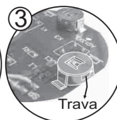
3- Encaixe as baterias LR 44 (Sempre com o pólo positivo (+) para cima) sob os suportes para módulo e empurre a trava do suporte para baixo.
