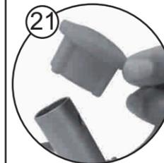
**21- Retire a proteção do tubo suporte da haste.**
