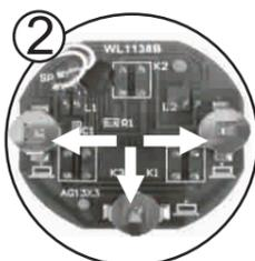
2- Retire o módulo de som do guidão e empurre as baterias conforme indicação das setas.
