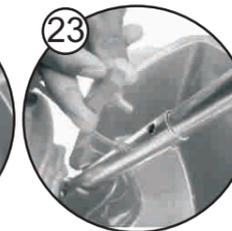
**23- Fixe a haste com o parafuso de cabeça plástica. (Parafuso menor)**
