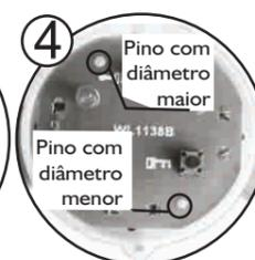
4- Encaixe o módulo no suporte, observe que o furo maior deverá ser encaixado no pino com diâmetro maior. Em seguida fixe a tampa com o parafuso.
