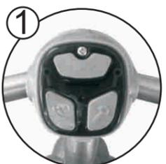
1- Com uma chave philips, retire o parafuso e a tampa para módulo.
