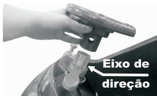
**01 -** Insira o volante no eixo de direção, alinhando o furo do volante com a trava do eixo de direção.
