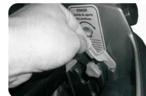
**05 -** Para total fixação da haste, gire a trava do parafuso da haste travando o parafuso.
